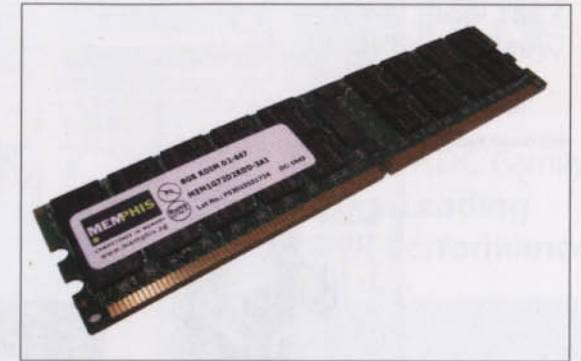
Bild 1. RDIMM-Speicher-Modul mit DDR2-ICs von Memphis.
